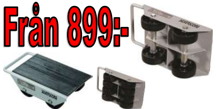
SF10 1Ton 4Hjul Art nr: 98SF10 / SF20 2 Ton 8Hjul Art nr: 98SF20 Skridskor används till att förflytta tungt gods. Hjulen i nylon gör att godset rullar lätt och sprider ut belastningen jämnt, för att undvika skador på underlaget. Svetsad stålkonstruktion av bockade plåtar med förstärkningsstag. Kraftig gummiskiva på ovansidan som skyddar lasten och förhindrar att lasten glider mot skridskon. Ej svängbara hjul. Kraftiga hjulaxlar. Praktiskt handtag. SF10 / 1 Ton /Ord listpris: 1250:- Ex moms! NU: 899:- Ex moms! SF20 / 2 Ton /Ord listpris: 1780:- Ex moms! NU: 1299:- Ex moms!
